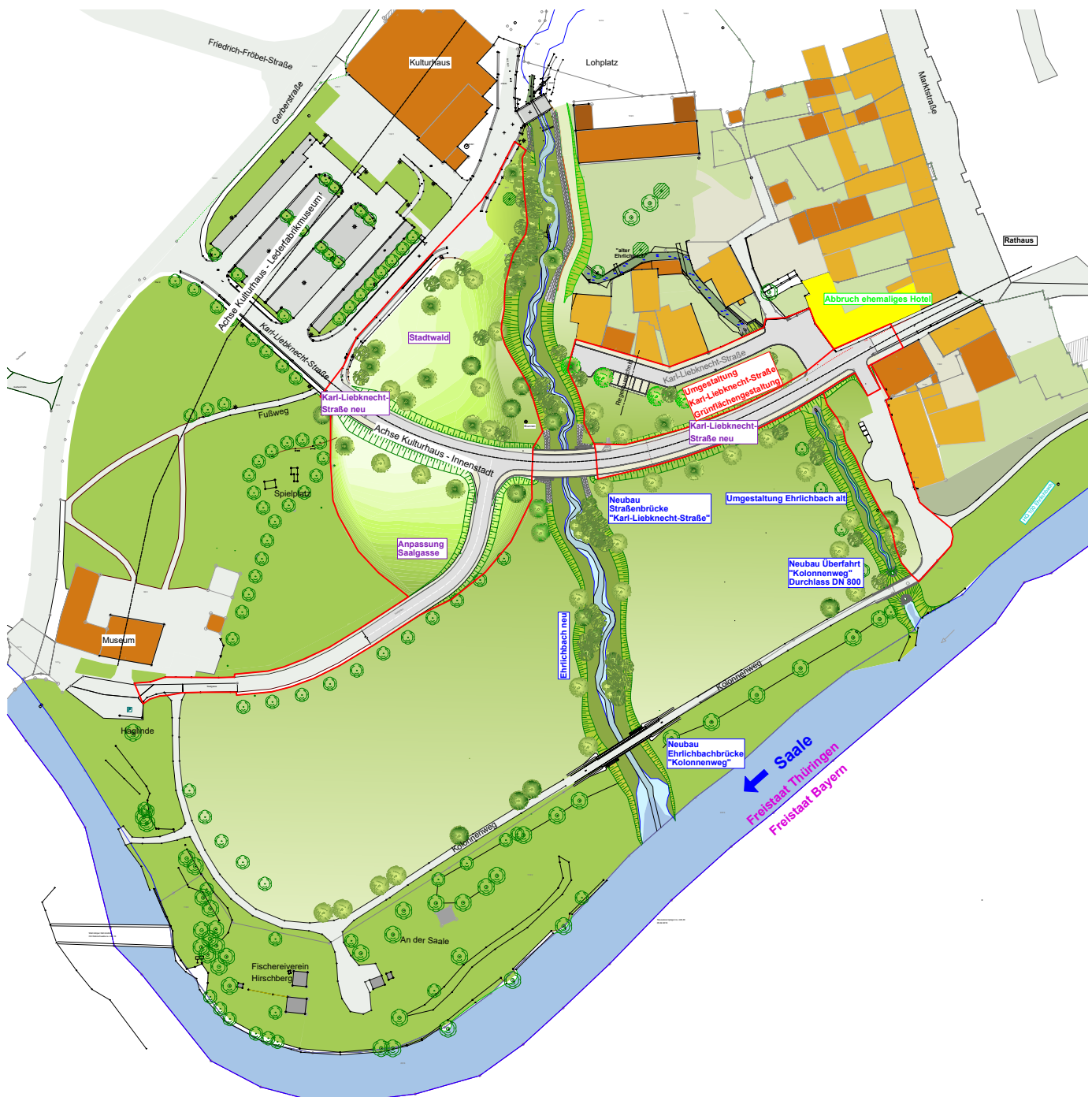
Abb. 8 Lageplan Hochwasserschutz am Ehrlichbach
